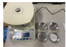
規定の時間に試験体を取り出し測りで重量を測定する
