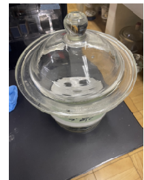
乾燥機から取り出した試験体をデシケーターで放冷する
